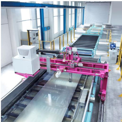
Bild 1: Prüftechnik auf höchstem Niveau: Durch die anspruchsvollen Anwendungen in der Luftfahrtindustrie haben sich auch die Anforderungen an die Prüftechnik nachhaltig erhöht. Im Bild - AMAG Luftfahrtplatten bei der Ultraschall-Prüfanlage, die eine mehrfach schnellere Qualitätsprüfung erlaubt.
