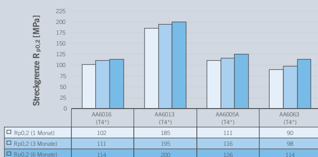
Abbildung 1: Streckgrenze R_{p0,2} für die untersuchten 6xxx Blechlegierungen im Zustand lösungsgeglüht T4* (schnell aushärtend) nach einem bis sechs Monaten.
