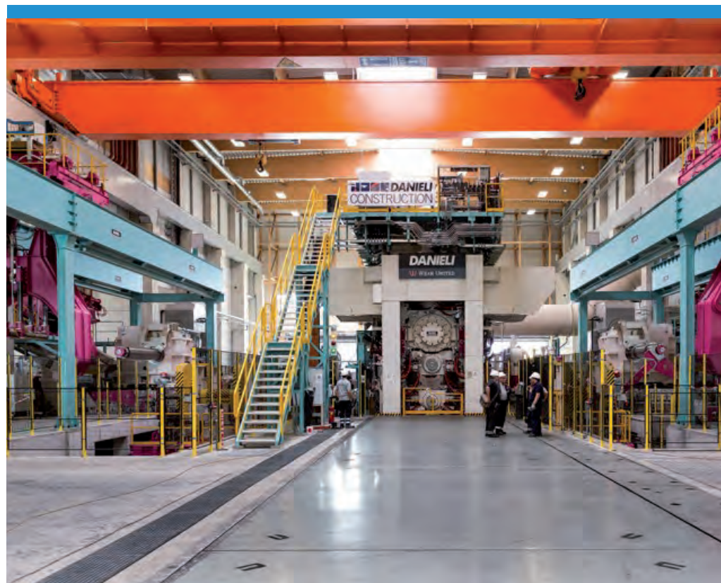
Neues Warmwalzgerüst für max. 2.300 mm breite Flachprodukte
