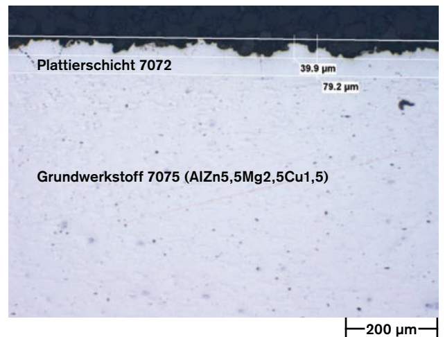
Bild 1: Oberflächlicher Angriff der Plattierschicht im Schichtkorrosionstest nach ASTM G34
