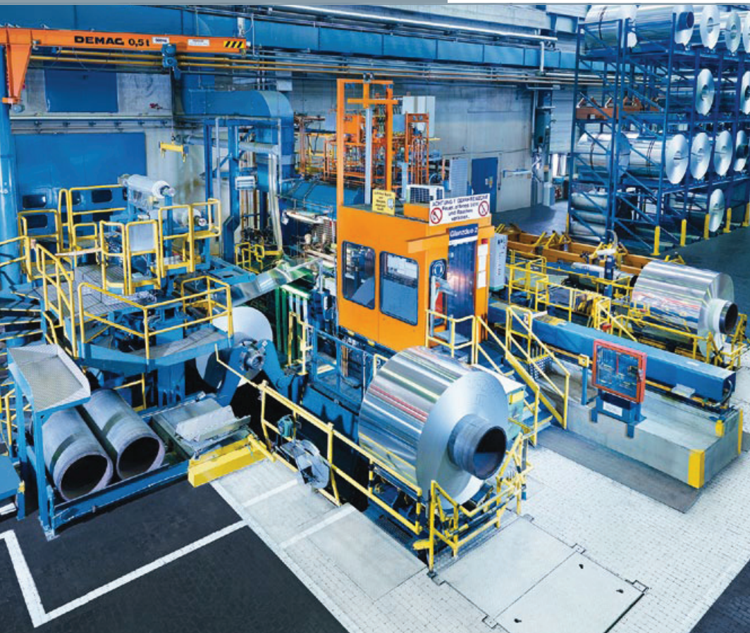
Abb. 1: Glanzwalzgerüst bei AMAG rolling
