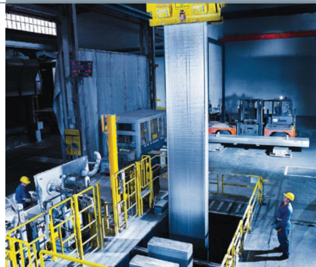
Abb. 3: Heben des Walzbarrens aus der Gießgrube
