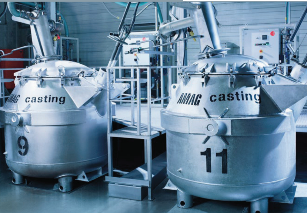
Warmhalten und Vorwärmen von Straßentransporttiegel mittels Gasbrenner
