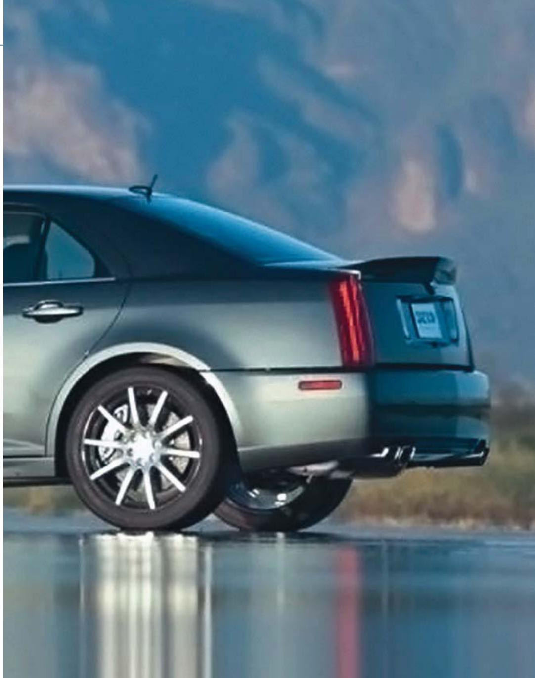
Gestaltungsfreiheit für komplexe Geometrien und Baugruppen – im Bild der Cadillac STS: Kofferraumdeckel aus AMAG TopForm® SPF
